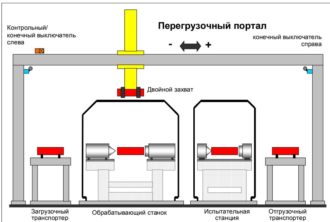
Перегрузочный портал оснащен двойным захватом (Захват 1: заготовка/ Захват 2: готовая деталь). Захват перемещается в горизонтальном направлении с помощью **серводвигателя**, в вертикальном направлении – с помощью пневматического цилиндра.
