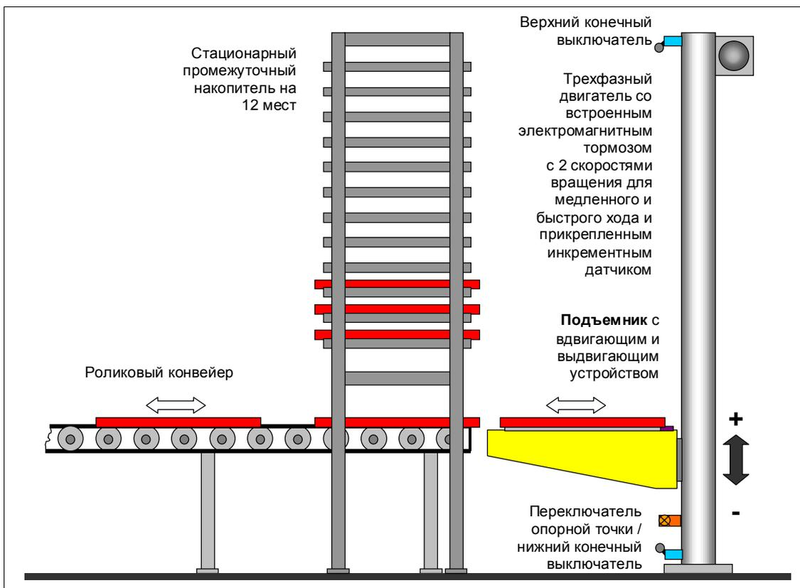
Задачей подъемника является снятие поддонов с деталями с роликового конвейера и складирование их в промежуточном накопителе.
