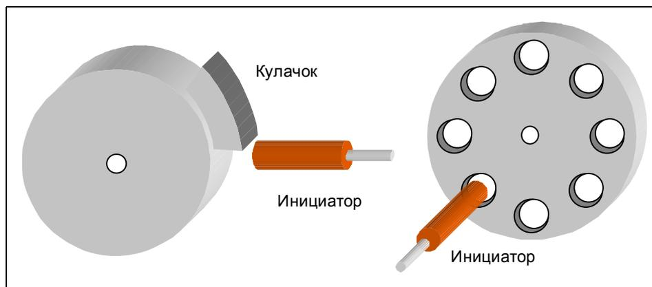
Импульсы могут генерироваться, напр., с помощью диска с отверстиями или включающего кулачка.
