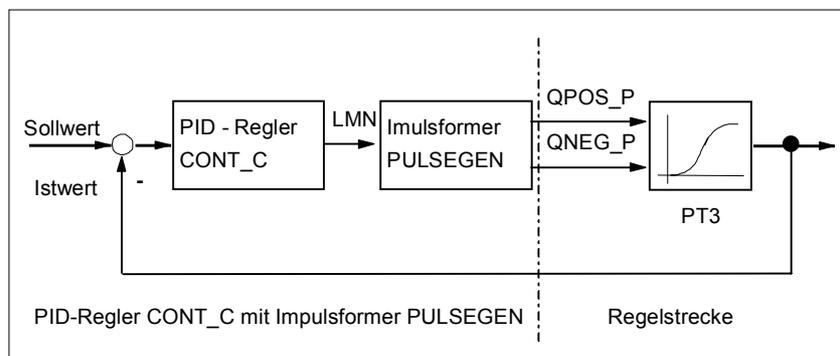
Пояснения к рисунку: Sollwert – заданное значение; Istwert – фактическое значение; PID-Regler – PID-регулятор; Impulsformer – формирователь импульсов; Regelstrecke – объект регулирования; PID-Regler CONT\_C mit Impulsformer PULSEGEN - PID-регулятор CONT\_C с формирователем импульсов PULSEGEN
