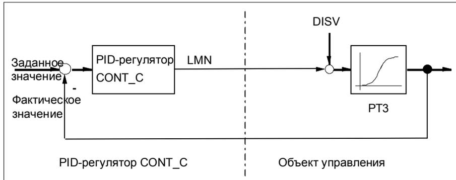
На следующем рисунке показаны структура и параметры блока PROC\_S, моделирующего объект управления. Системный функциональный блок PROC\_C моделирует последовательное соединение трех апериодических звеньев 1-го порядка. К выходному сигналу исполнительного устройства всегда добавляется возмущающее воздействие **DISV**, так что в этом месте могут быть вручную подключены помехи на объекте управления. Через коэффициент **GAIN** можно определить статический коэффициент передачи объекта управления:
